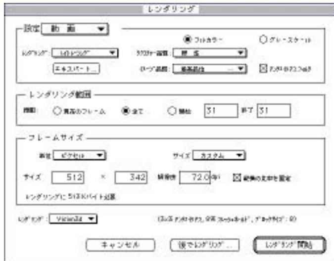
「レンダリング開始」ボタンをクリックすればすぐにレンダリングが始まります。「後でレンダリング」ボタンをクリックすると、夜間や休日など、コンピュータが空いている時間にレンダリングすることができます。
