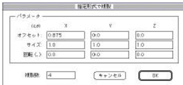
複製するオブジェクトのX軸のオフセットを0.875インチに設定します。YとZ軸は0.0のままです。サイズの項目には1.0のままにして、複製数を4にして「OK」ボタンをクリックします。
